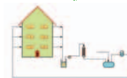
Progetto ACQUASAVE: schema riuso acque grigie
